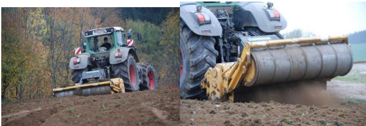
Abb.8: Tiefenfräse in Betrieb
